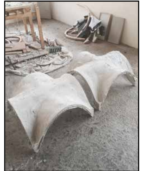
Figura 3: Modelos desarrollados como parte del experimento y análisis del nuevo sistema de moldura.
